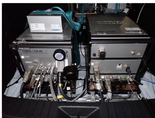
図1 車載式排出ガス測定システム（PEMS）
