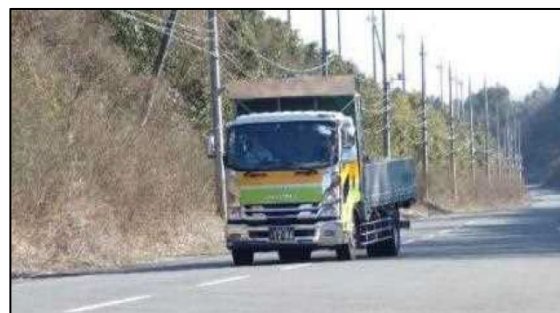
図5 EBS 搭載車両の基礎実験 (車速 60km/h からの制動を繰り返し、ライニング温度を確認)
