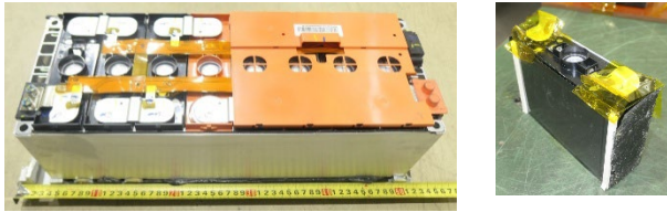
図 3. 対象電池の外観（左）モジュール、（右）セル
