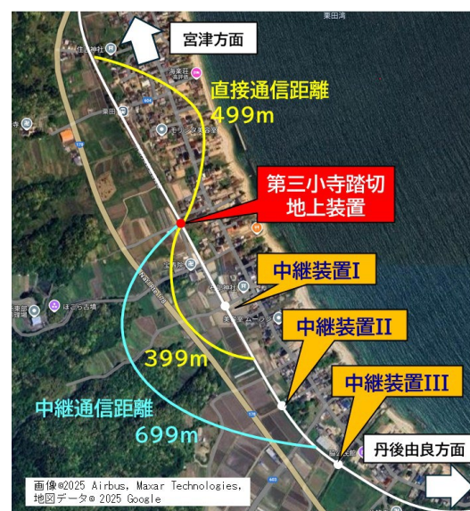
図 6 現地試験における通信成立距離
