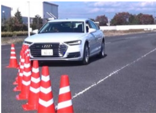
図3 自動運転レベル2運転支援システムの調査 (工事現場を模したカラーコーンに対する検知と反応を調査)
