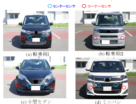
図 1 車両前方ソナー装着状況概観
