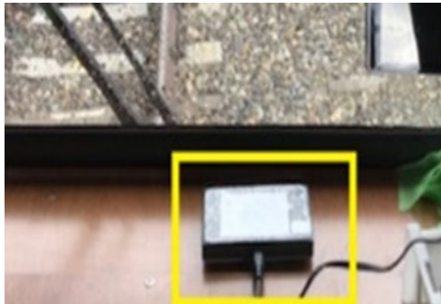
図 2 小型端末による車両動揺の計測
