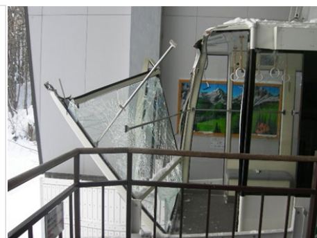
図2 搬器衝突事故後の搬器
