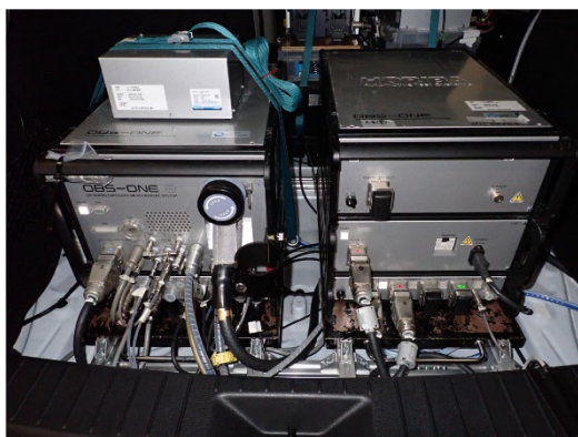
図 1 車載式排出ガス測定システム（PEMS）
