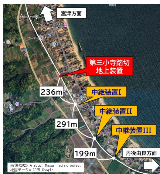
図 5 現地試験における各装置の配置
