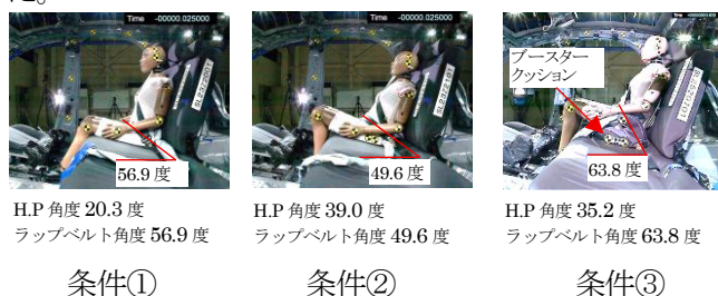
図4 ダミーの搭載条件
