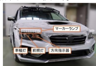
図 1 評価用マーカーランプと実験車両の灯火器
